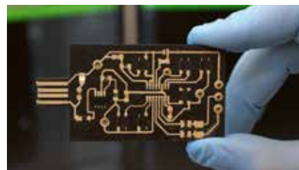
Vzorek funkční DPS vyrobený z odpadního plastu
