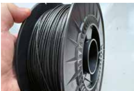
Filament z odpadní drti z výroby vinylových desek
