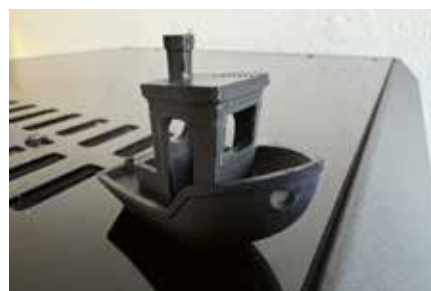
Ukázka 3D tisku z vyvinutého filamentu
