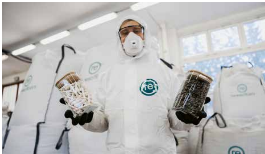
Výroba granulátu využitelného při výrobě asfaltových směsí jako náhrada vstupní suroviny – celulózy
