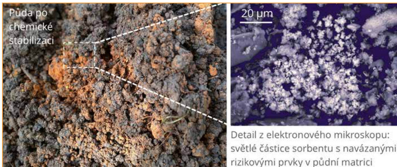
Obrázek 1: Aplikace železitého kalu pro záchyt kontaminantů v půdě a elektronová mikroanalýza
