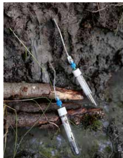
Obrázek 2: Odběry půdní pórové vody pro ověření mobility rizikových prvků
