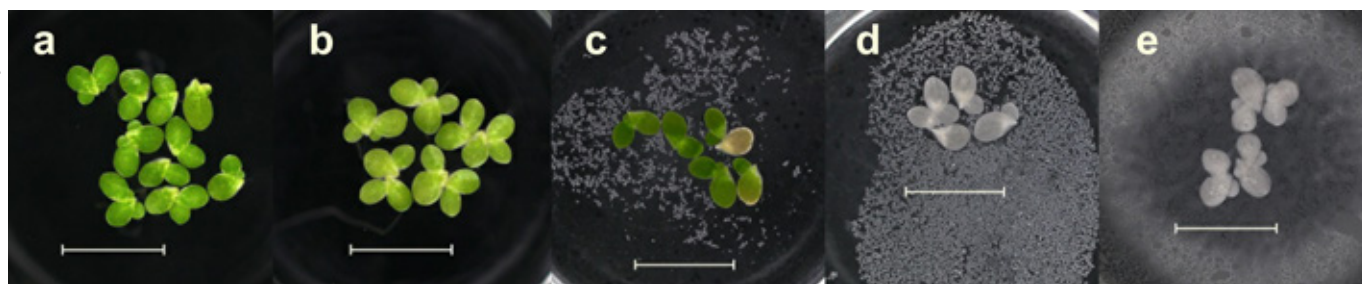
Obrázek 3: Reakce okřehku na různé stresové faktory: a) Kontrolní roztok: Optimální růst a vitalita. b) Roztok \text{CaCl}_2 : Stres z nedostatku živin – zejména chloróza. c) Příklad výluhu SDO s nízkou tlumivou kapacitou – zastavení růstu. d) Letální účinek výluhu z SDO s vysokým obsahem cementu – nekróza. e) Roztok \text{Ca}(\text{OH})_2 : Modelový příklad potvrzující letální účinky vysokého pH a tlumivé kapacity
