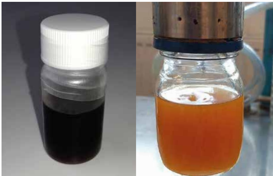
Obrázek 3: Pyrolýzní olej surových (vlevo) a přečištěných separátorů (vpravo)
