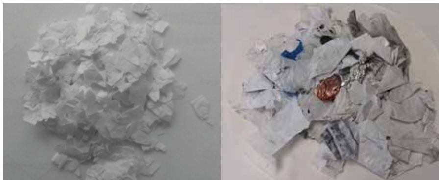
Obrázek 1: Surové separátory (vlevo) a přečištěné separátory (vpravo)
