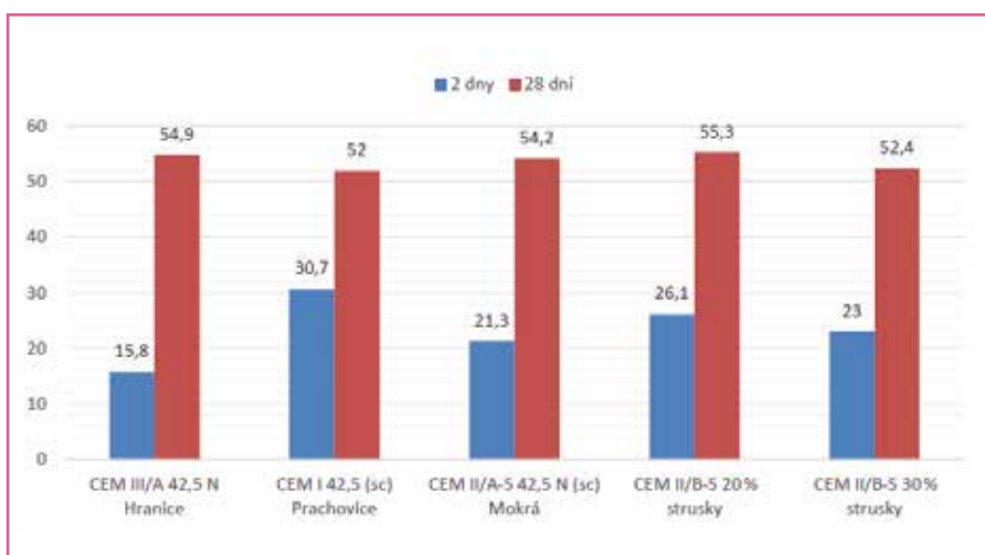
Graf 2: Pevnost betonu horní vrstvy CBK v porovnání stáří 2 a 28 dní [MPa]
