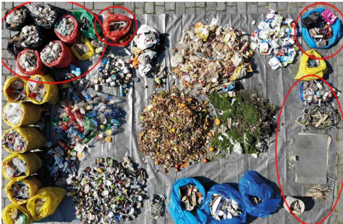
Obrázek: Roztříděný vzorek SKO (zakroužkované odpady patří do černé nádoby na odpad, zbytek bylo možné vytrídít)
